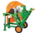
Wippsäge zum sicheren Ablängen von Kaminholz, für max. Scheitkantlänge von 25 cm
