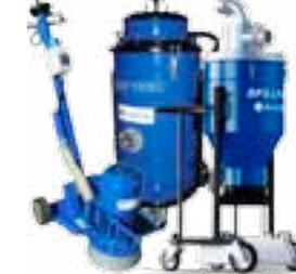
Bodenschleifpaket für große Flächen ab 50 m<sup>2</sup>, inkl. passendem Vorabscheider und Absauganlage
