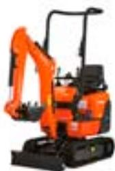
kleinster Bagger ohne Dach und verstellbarer Spurbreite von 70 – 90 cm, ideal für engste Durchfahrten (Türen), Kraftstoff Diesel
