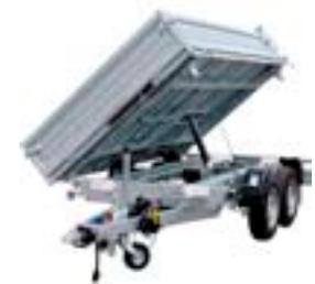
ideal für den Transport von Baustoffen, Schüttmaterial, Sand, Schotter, Kies usw., hydraulische Drei-Seiten-Kippvorrichtung
