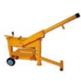
einfaches Zuschneiden von Platten, Steinen, usw.
