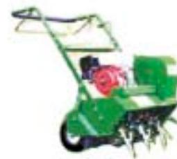
sticht kleine Löcher durch Hohlspoons in den Rasen, für bessere Belüftung & Wasserablauf bei sehr lehmhaltigen Böden
