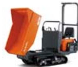
für Ladearbeiten auf engstem Raum, hydraulisch kippbar nach vorne
