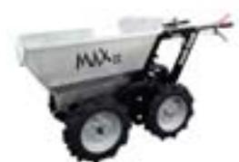
schwere Motorschubkarre mit max. Zuladung von 550 kg, für größere Transportarbeiten
