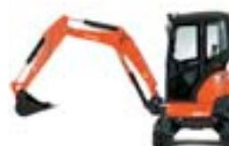
Allroundmaschine bei beengten Platzverhältnissen, langer Löffelstiel für große Reichweite und Grabtiefe, verstellbares Kettenfahrwerk, Kraftstoff Diesel
